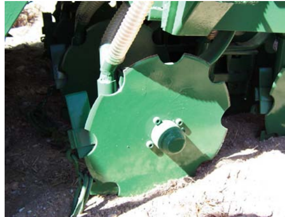
Doğrudan (Direk) Ekim Makinesi Parçalayıcı ve Gömücü Ünitesi
